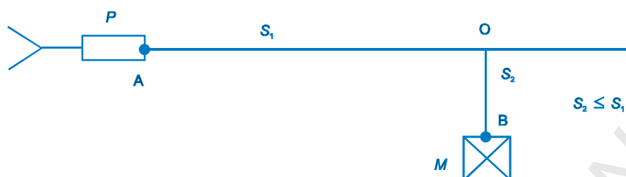
Figure 433E – Exemple de dispense de protection contre les surcharges L'appareil d'utilisation comporte sa protection incorporée contre les surcharges
